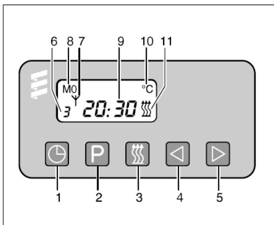
После подачи питания на таймер отопителя все символы и цифры показаны на дисплее с миганием - таймер отопителя необходимо полностью настроить. В таком положении таймера отопитель не запускается.
